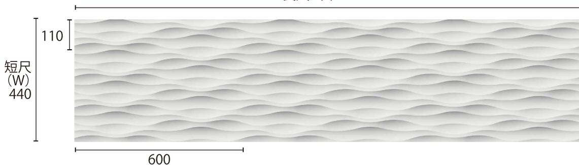
曲げ方向は長尺方向を推奨します。
