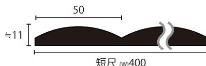
曲げ方向は長尺方向を推奨します。
