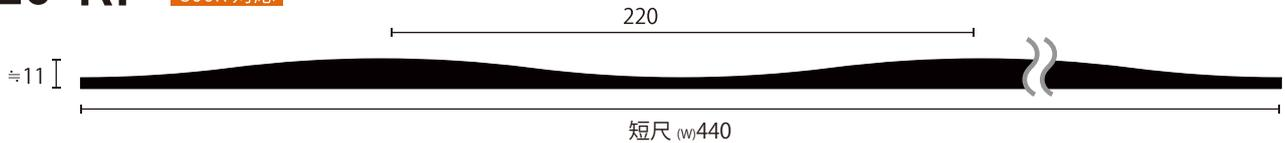
曲げ方向は長尺方向を推奨します。
