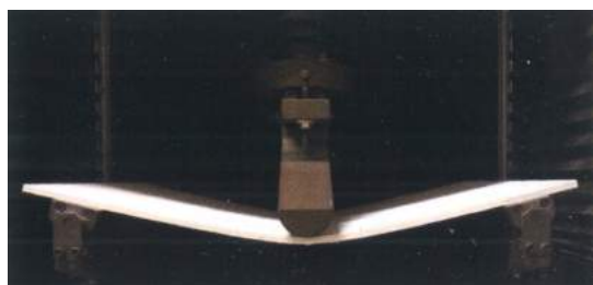
400mm スパンにて中央集中線荷重を加えて破壊までのたわみ。
